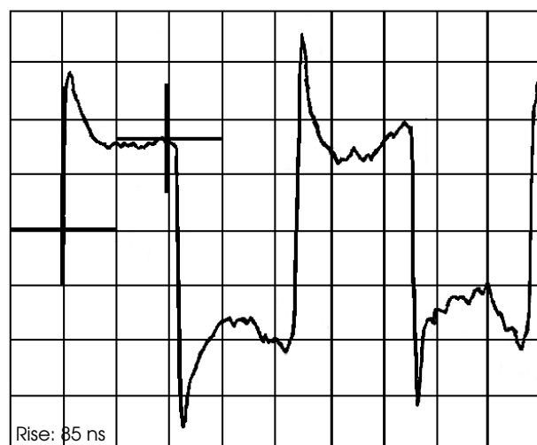
Abbildung 4.12: Hydrophonantwort auf einen ebenen Drucksprung mit P_r = 37\,100 Pa
